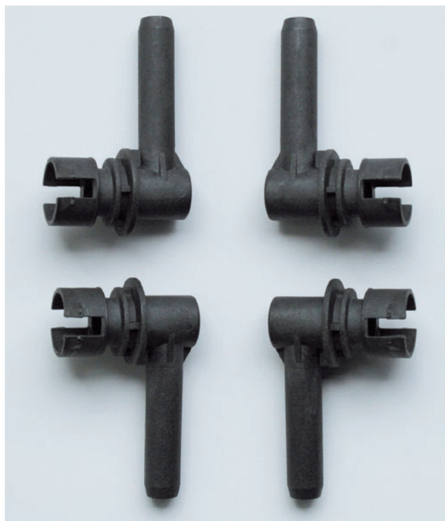
Bei diesen Entlüfterkappen von Hähl erkennt man deutlich den Vorteil von Active Flow Balance: Links die Bauteile ohne: Die vier Kavitäten des Werkzeugs waren nicht gleichmäßig gefüllt. Rechts die Bauteile mit Active Flow Balance: mit einem ausbalancierten Füllverhalten des Werkzeugs und damit einer reproduzierbar hohen Teilequalität in allen Kavitäten Foto: Sumitomo (SHI) Demag
