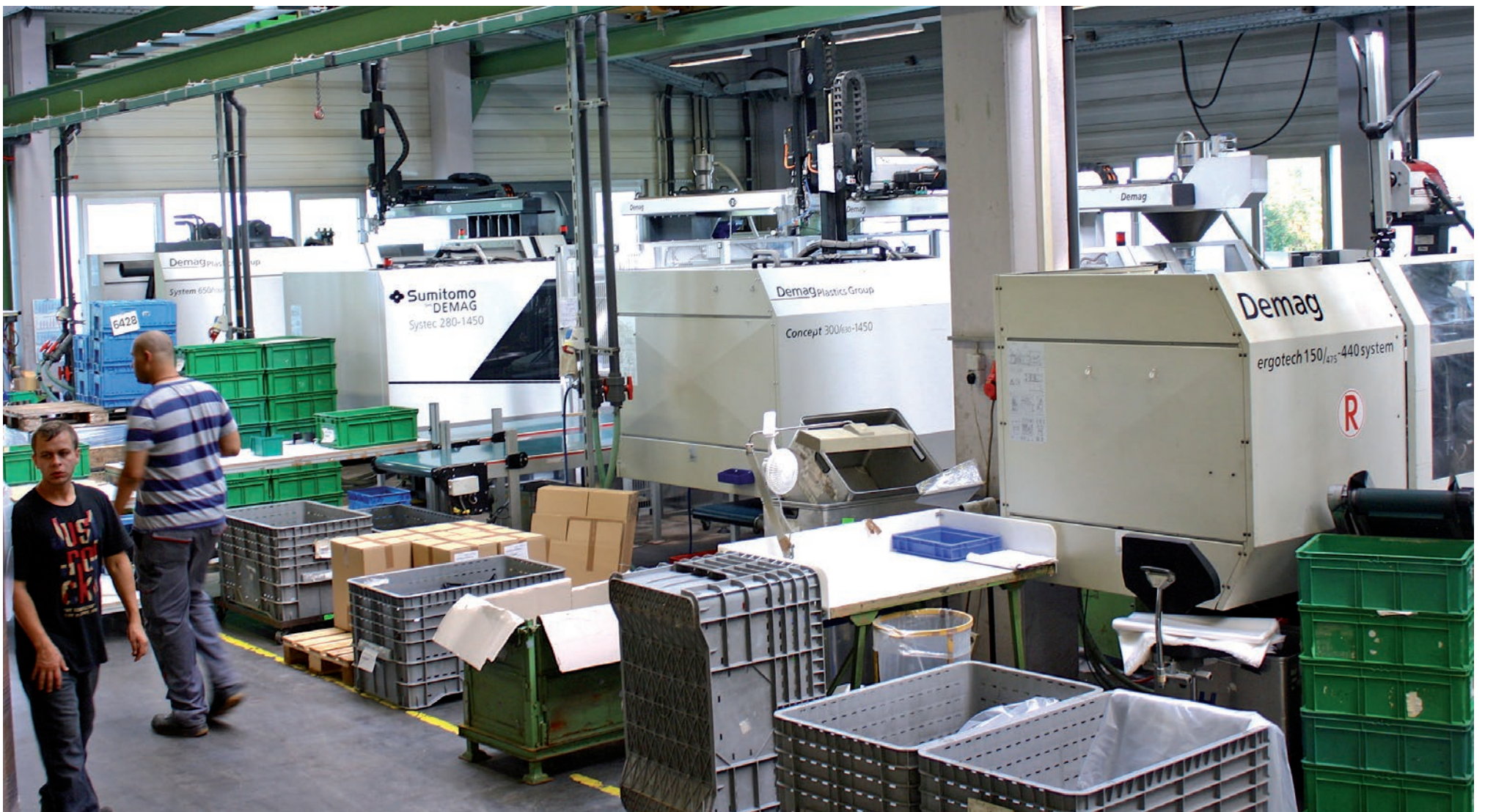
Sieben der insgesamt 30 Spritzgießmaschinen bei Hähl stammen von Sumitomo (SHI) Demag, darunter auch zwei vollelektrische der Intellect-Baureihe Foto: Sumitomo (SHI) Demag
