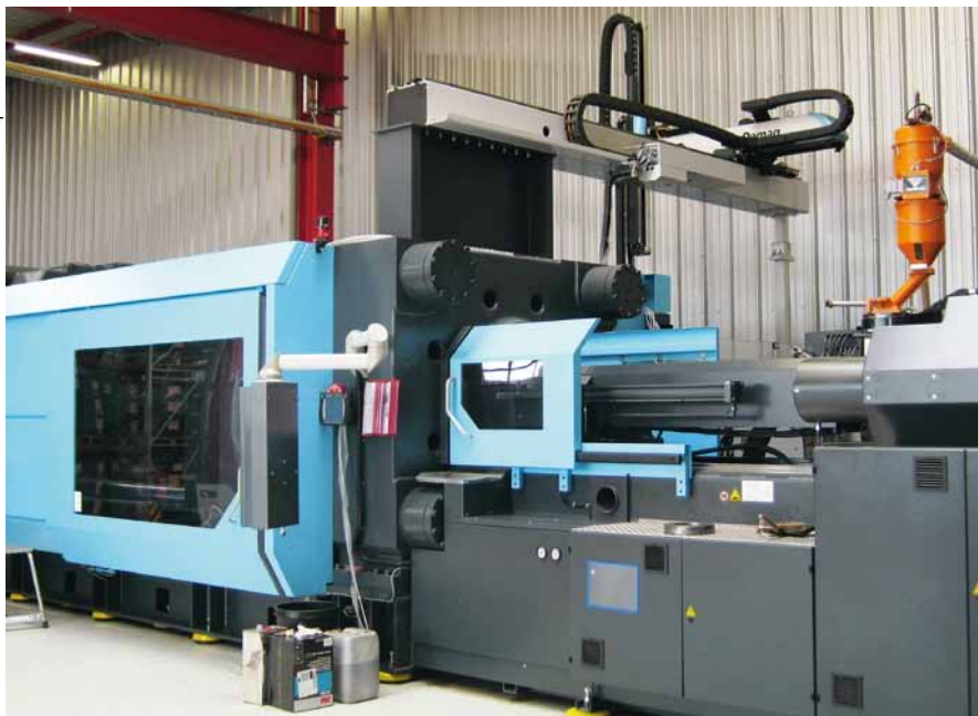
▲ Große Maschine für große Bauteile: Die Halterahmen der Stoßfänger werden auf einer Spritzgießmaschine mit 15.000 kN Schließkraft gespritzt.
