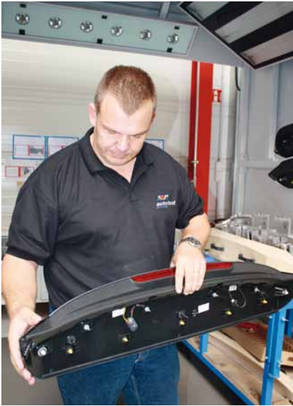
▲ Karl Menrad begutachtet einen Heckspoiler. Für solche Bauteile werden Spritzgießtechnik und Polyurethan-Verarbeitung kombiniert.
