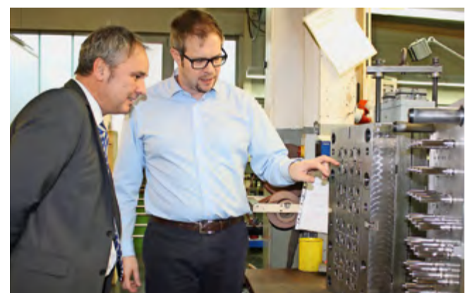
Geschäftsführer Sascha Möhs (r.) zeigt Andreas Zwiener, Vertriebsingenieur bei Sumitomo (SHI) Demag, das 32-fach-Werkzeug, bei dem die optimale Füllung aller Kavitäten auf elektrischen Maschinen in der Vergangenheit Sorgen bereitete. Foto: K-ZEITUNG
