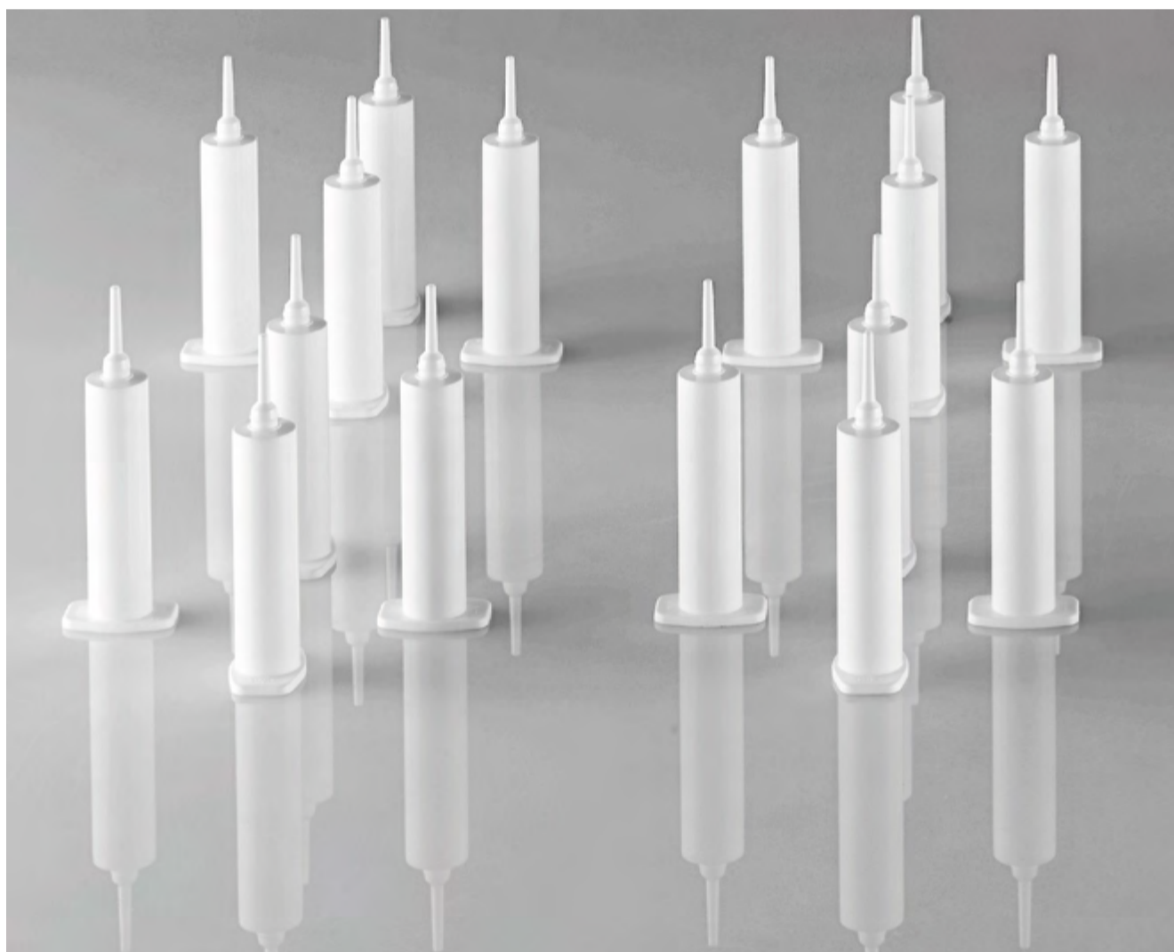
Der Qualitätscheck zeigt den Unterschied: links die unterfüllten Injektoren ohne Zuschaltung von Active Flow Balance, rechts mit der Funktion Foto: Sumitomo (SHI) Demag
