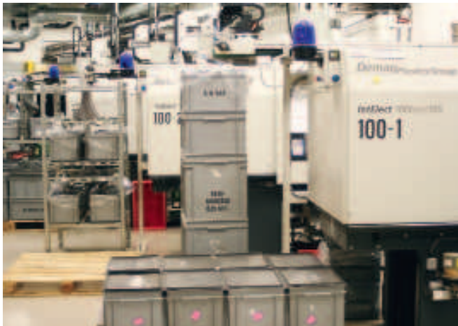
Ob Zahnrad oder Elementeträger: Von den über zwölf Intellect-Maschinen produzieren die meisten Produkte, die in Murten zur Fertigung von Kleinmotoren und Antrieben weiterverwendet werden.
